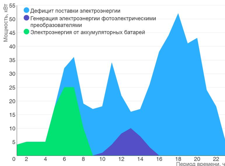
Рис. 7. Обеспечение электрической нагрузки инфраструктурного объекта
